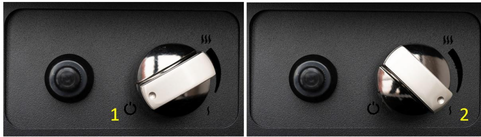
Fig 11 – Accensione del dispositivo
